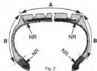
**A** Bande de roulement du pneu
